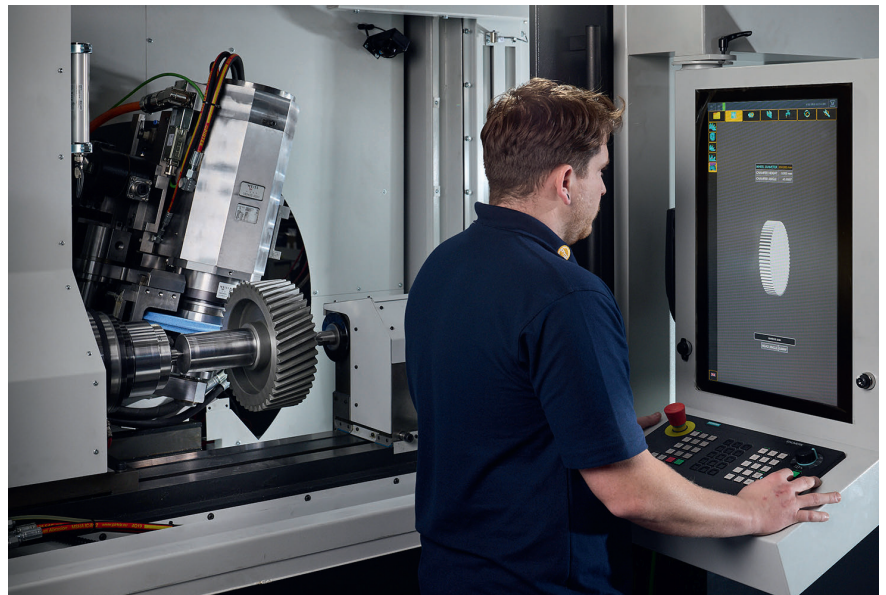
1 Blick in den Arbeitsraum des neuen Zahnradschleifzentrums ›HG350-G‹ von PTG Holroyd, rechts die erstmals adaptierte Siemens-Steuerung ›Sinumerik One‹ © PTG Holroyd
